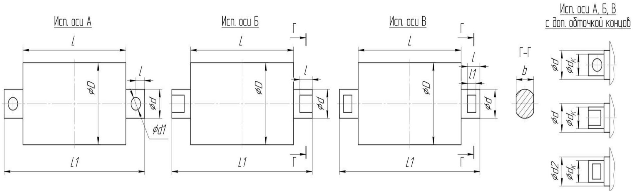
Ролики пластиковые с разборной конструкцией подшипникового узла и лабиринтного уплотнения.
